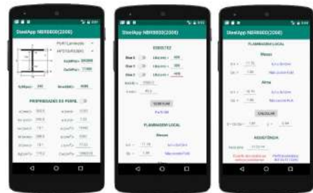
Figura 3: Verificação de elemento de aço sob compressão
